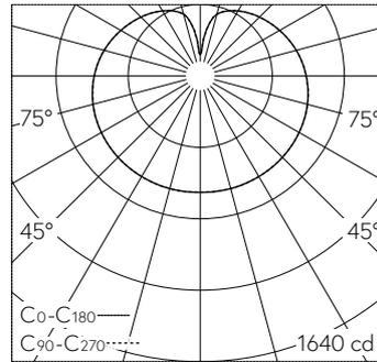
LED 4000 K 65 W 7257 lm-h / CIE Flux 26 51 75 56 100 / C22 nach DIN 5040
