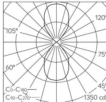
LED 3000 K 120 W 12840 lm-h / CIE Flux 85 99 100 50 100 / C84 nach DIN 5040
