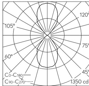
LED 3000 K 240 W 25680 lm-h / CIE Flux 85 99 100 50 100 / C84 nach DIN 5040
