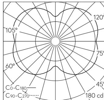
LED 3000 K 120 W 9540 lm-h / CIE Flux 22 48 74 50 100 / C12 nach DIN 5040
