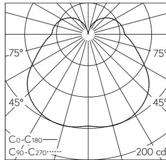
LED 4000 K 120 W 9692 lm-h / CIE Flux 35 64 84 71 100 / B31 nach DIN 5040
