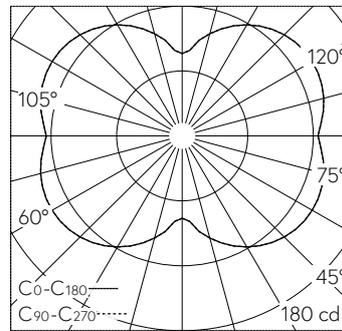
LED 4000 K 160 W 12920 lm-h / CIE Flux 22 48 74 50 100 / C12 nach DIN 5040
