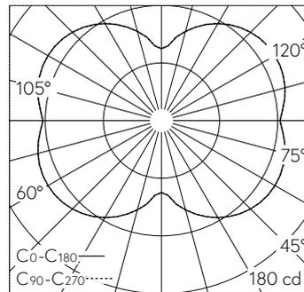
LED 3000 K 240 W 19080 lm-h / CIE Flux 22 48 74 50 100 / C12 nach DIN 5040
