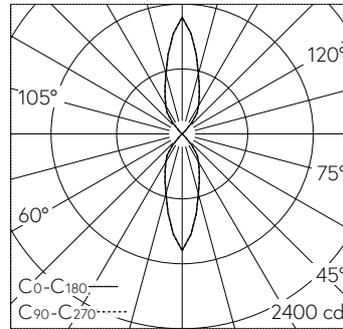
LED 3000 K 240 W 19368 lm-h / CIE Flux 94 99 100 50 100 / C84 nach DIN 5040
