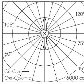
LED 3000 K 240 W 21960 lm-h / CIE Flux 93 98 100 50 100 / C84 nach DIN 5040
