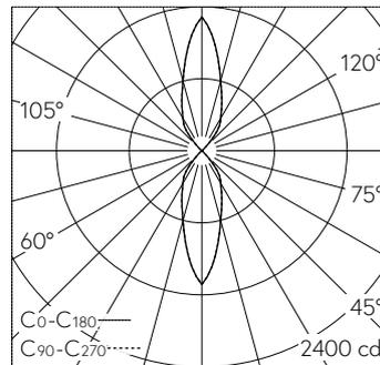
LED 3000 K 240 W 20664 lm-h / CIE Flux 93 99 100 50 100 / C84 nach DIN 5040
