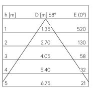
LED 3000 K 12.3 W 685 lm-h 74° / CIE Flux 80 96 100 100 100 / A70 nach DIN 5040
