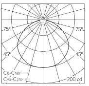
LED 3000 K 7.3 W 486 lm-h / CIE Flux 47 80 96 94 100 / A43 nach DIN 5040
