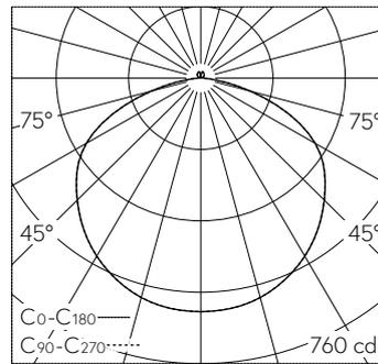
LED 3000 K 20.6 W 2035 lm-h / CIE Flux 44 77 96 97 100 / A43 nach DIN 5040
