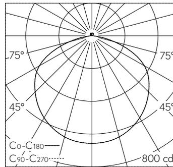
LED 4000 K 20.6 W 2150 lm-h / CIE Flux 44 77 96 97 100 / A43 nach DIN 5040
