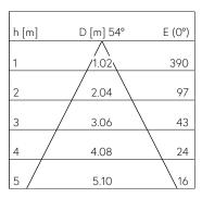
LED 3000 K 13 W 452 lm-h 56° / CIE Flux 75 92 98 100 100 / A60 nach DIN 5040
