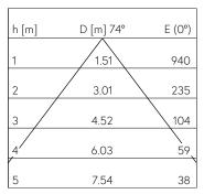
LED 3000 K 28.8 W 1535 lm-h 74° / CIE Flux 79 91 98 100 100 / A70 nach DIN 5040
