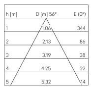
LED 3000 K 13 W 470 lm-h 56° / CIE Flux 67 88 97 100 100 / A60 nach DIN 5040
