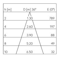
LED 3000 K 19 W 1861 lm-h 36° / CIE Flux 93 98 100 100 100 / A80 nach DIN 5040
