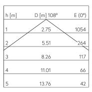
LED 3000 K 29.5 W 2776 lm-h 108° / CIE Flux 52 85 98 100 100 / A40 nach DIN 5040
