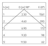
LED 3000 K 47.4 W 3460 lm-h 98° / CIE Flux 61 92 99 100 100 / A50 nach DIN 5040
