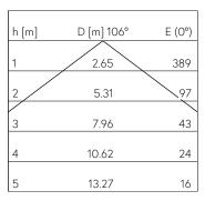
LED 3000 K 15.5 W 1009 lm-h 106° / CIE Flux 51 82 97 100 100 / A40 nach DIN 5040
