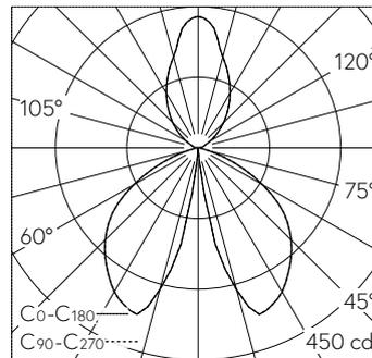
LED 3000 K 19,5 W 1358 lm-h / CIE Flux 50 87 99 74 100 / B44 nach DIN 5040
