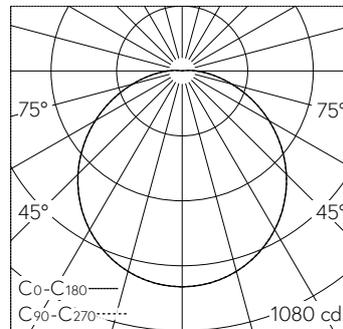
LED 3000 K 29.4 W 2754 lm-h / CIE Flux 45 75 92 99 100 / A40 nach DIN 5040
