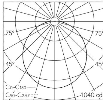
LED 3000 K 29.4 W 2708 lm-h / CIE Flux 45 75 92 99 100 / A40 nach DIN 5040
