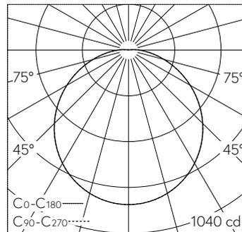
LED 3000 K 29.4 W 2682 lm-h / CIE Flux 45 75 92 99 100 / A40 nach DIN 5040
