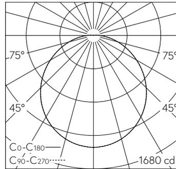
LED 3000 K 47.4 W 4199 lm-h / CIE Flux 45 76 93 99 100 / A40 nach DIN 5040
