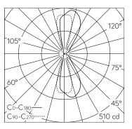
LED 3000 K 19.5 W 443 lm-h / CIE Flux 74 89 96 50 100 / C64 nach DIN 5040
