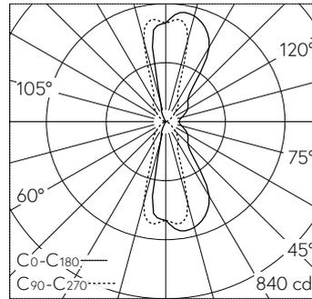
LED 3000 K 28 W 962 lm-h / CIE Flux 63 82 92 50 100 / C53 nach DIN 5040
