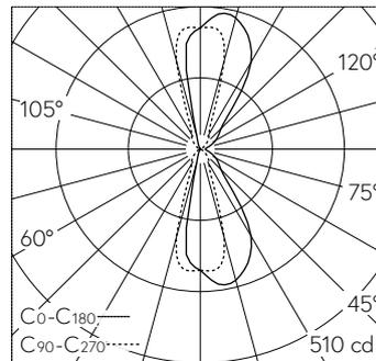
LED 3000 K 19.5 W 443 lm-h / CIE Flux 74 89 96 50 100 / C64 nach DIN 5040
