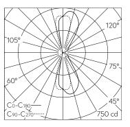
LED 3000 K 28 W 642 lm-h / CIE Flux 74 90 97 50 100 / C64 nach DIN 5040
