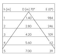
LED 3000 K 20 W 1455 lm-h 70° / CIE Flux 70 92 98 100 100 / A60 nach DIN 5040
