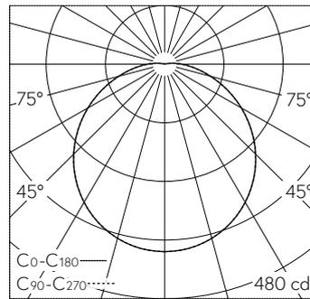
LED 3000 K 15.5 W 1209 lm-h / CIE Flux 44 74 91 98 100 / A30 nach DIN 5040
