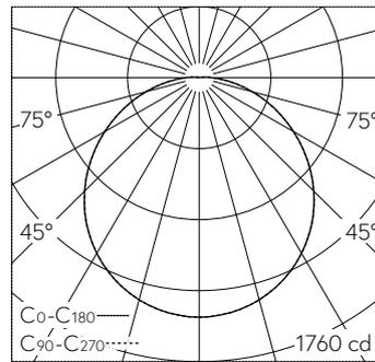
LED 3000 K 47.4 W 4467 lm-h / CIE Flux 45 76 93 99 100 / A40 nach DIN 5040
