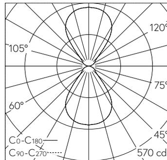
LED 3000 K 19.5 W 1129 lm-h / CIE Flux 74 90 98 50 100 / C64 nach DIN 5040
