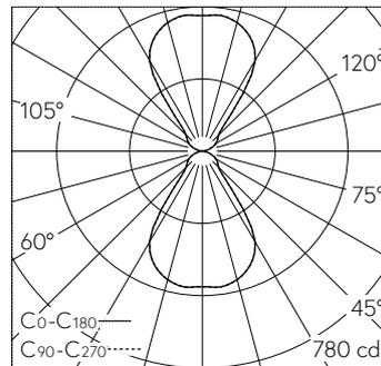
LED 3000 K 28 W 1456 lm-h / CIE Flux 74 90 98 50 100 / C64 nach DIN 5040
