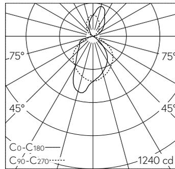
LED 3000 K 19.5 W 1358 lm-h / CIE Flux 53 82 96 73 100 / B43 nach DIN 5040
