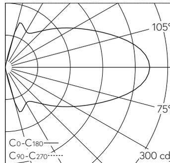
LED 3000 K 36.5 W 530 lm-h / CIE Flux 14 36 63 50 100 / C11 nach DIN 5040
