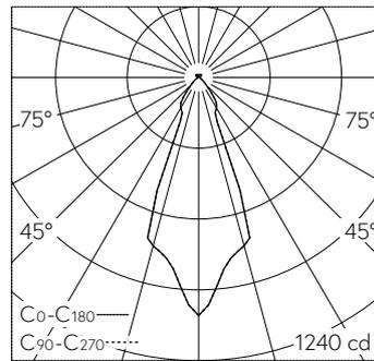
LED 3000 K 18 W 584 lm-h / CIE Flux 89 98 100 90 100 / A83 nach DIN 5040
