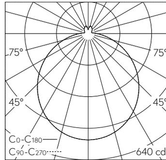
LED 3000 K 21 W 1803 lm-h / CIE Flux 44 75 92 91 100 / A42 nach DIN 5040
