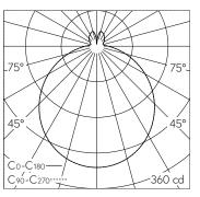
LED 3000 K 16.8 W 1087 lm-h / CIE Flux 44 74 91 86 100 / B42 nach DIN 5040
