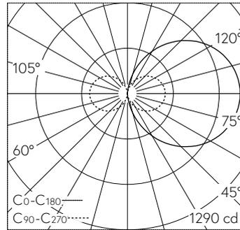
LED 3000 K 44 W 4172 lm-h / CIE Flux 13 37 66 50 100 / C11 nach DIN 5040
