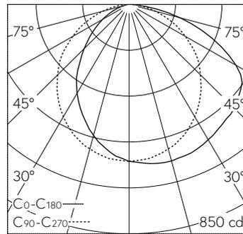
LED 3000 K 24.8 W 1651 lm-h / CIE Flux 47 78 96 100 100 / A40 nach DIN 5040
