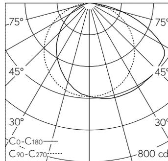
LED 3000 K 24.8 W 1428 lm-h / CIE Flux 45 77 96 100 100 / A40 nach DIN 5040
