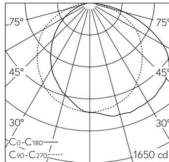
LED 3000 K 38.5 W 3430 lm-h / CIE Flux 45 77 95 100 100 / A40 nach DIN 5040
