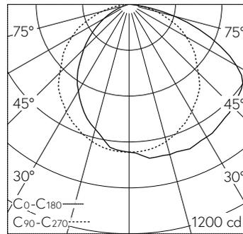
LED 3000 K 38.5 W 2278 lm-h / CIE Flux 46 79 96 100 100 / A40 nach DIN 5040
