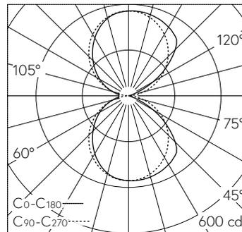
LED 3000 K 31 W 2033 lm-h / CIE Flux 50 82 96 50 100 / C43 nach DIN 5040
