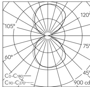
LED 3000 K 50 W 3067 lm-h / CIE Flux 49 81 96 50 100 / C43 nach DIN 5040
