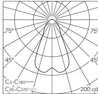
LED 4000 K 4.8 W 182 lm-h / CIE Flux 70 89 96 100 / A61 nach DIN 5040
