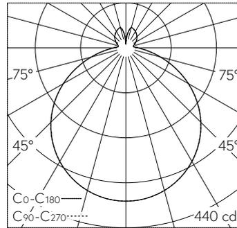
LED 4000 K 13.3 W 1341 lm-h / CIE Flux 45 75 92 86 100 / B42 nach DIN 5040
