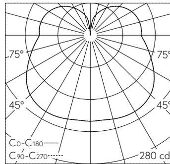
LED 3000 K 16 W 1571 lm-h / CIE Flux 31 58 80 62 100 / B21 nach DIN 5040
